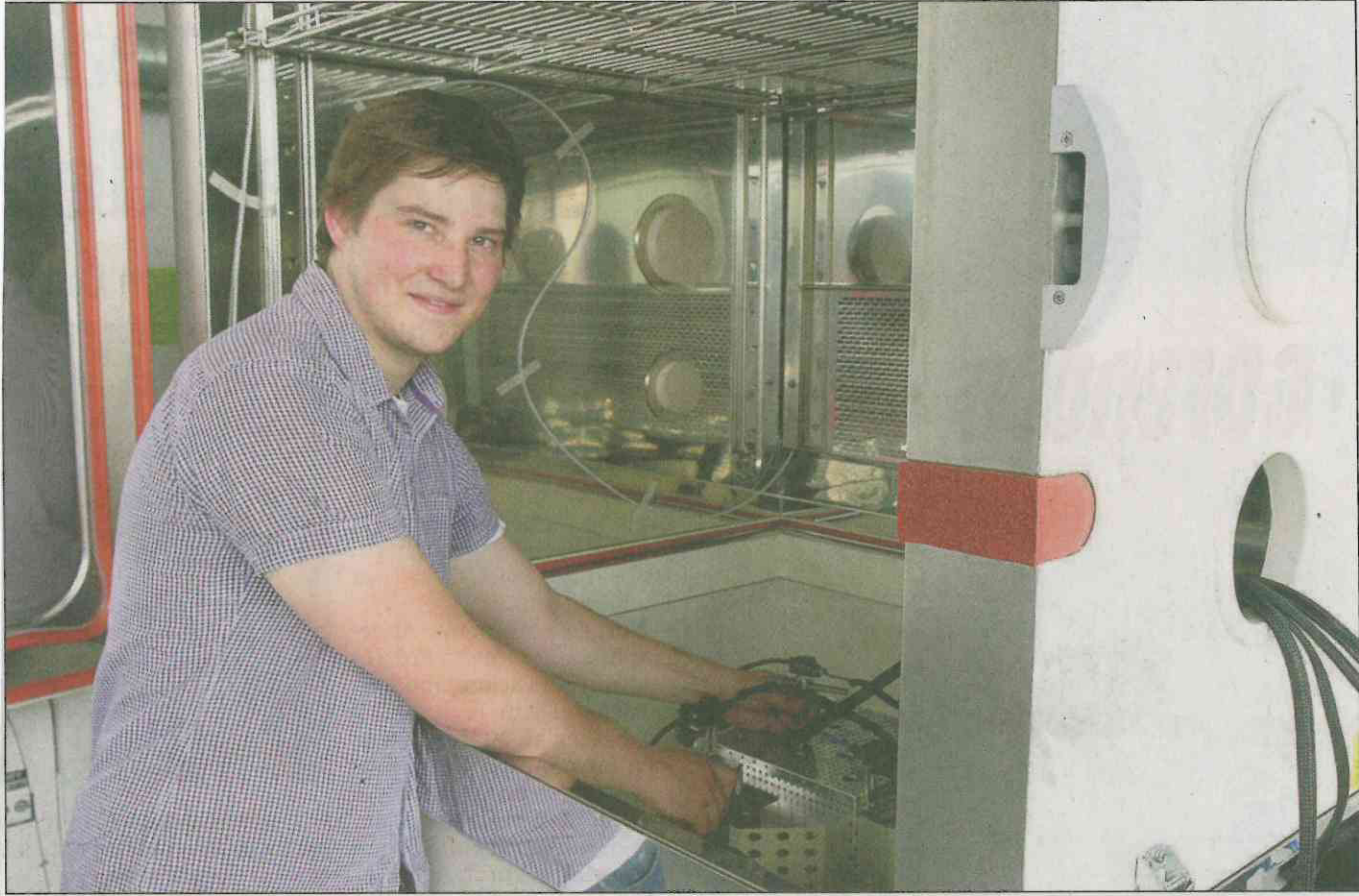
An dem würfelförmigen Gleittisch des Schwingerregers kann Laborleiter Stefan Menke die Prüfteile in unterschiedlicher Ausrichtung befestigen. Der Shaker kann übrigens um 90 Grad gedreht werden. Die ersten Tests sind am Montag und Dienstag bereits gelaufen.
