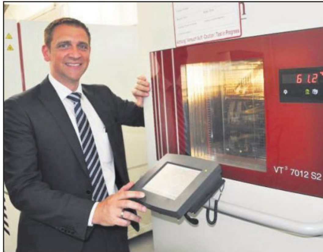
Tobias Möller vor einem Prüfschrank des Umweltlabors, in dem ein Steuerungs-Panel beschleunigt um rund 20 Jahre altert. Foto: Osmic
