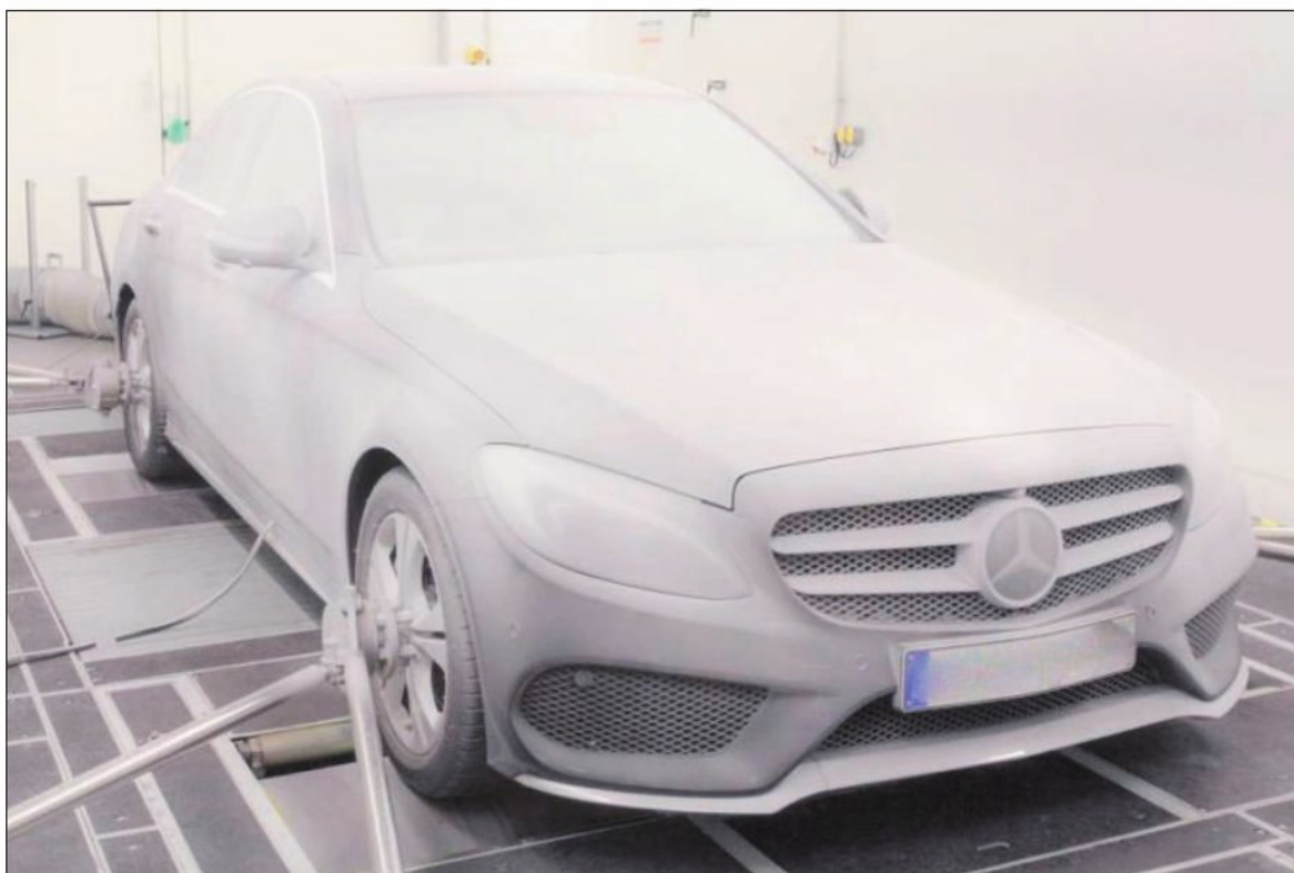
Glücklich, wer hier eine gute Heizung hat: Der Klima-Rollenprüfstand des KFE in Lippstadt simuliert Temperaturen in einer Spannweite von plus 50 bis minus 30 Grad.
